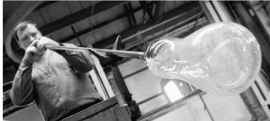
Etwa 1150 Grad ist Glas heiß, wenn es von einem Glasmacher in die richtige Form gebracht wird. FOTO: DPA
